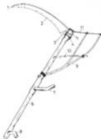
Kosa z Kolárova: 1. hrot, 2. ostrie, 3. krk kosa, 4. železná obrúčka, 5. klin, 6. kosisko, 7. veľká rúčka, 8. malá rúčka, 9. násadec, 10. napínací prút, 11. špagát (Gudmonová 1992, 92)
