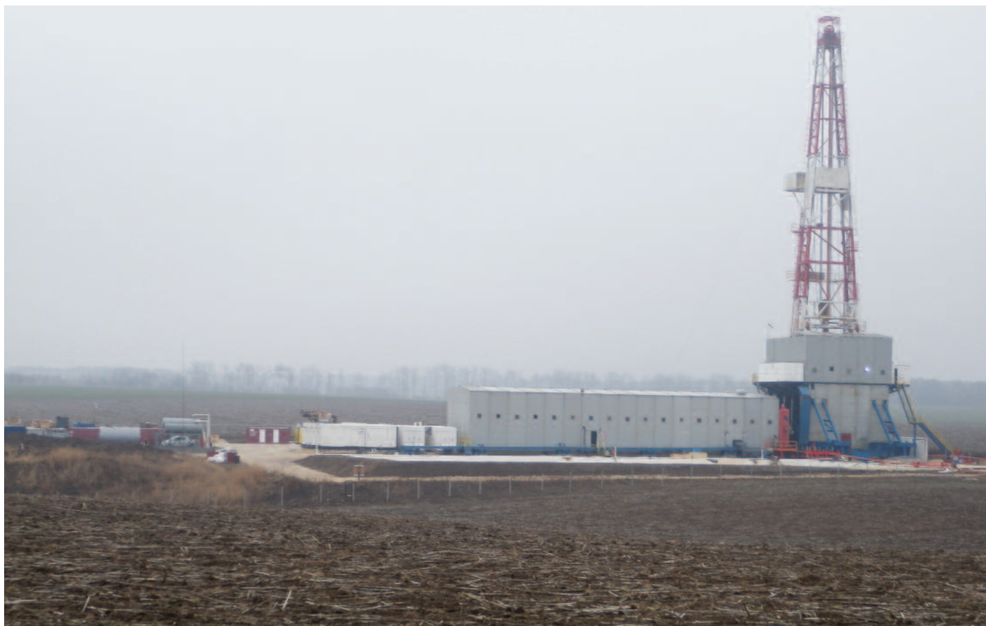
Palagázfúrótorony Bulgáriában. Minden fúrótorony esetében kb. 4 hektár területre van szükség az összes infrastruktúra felállításához.
