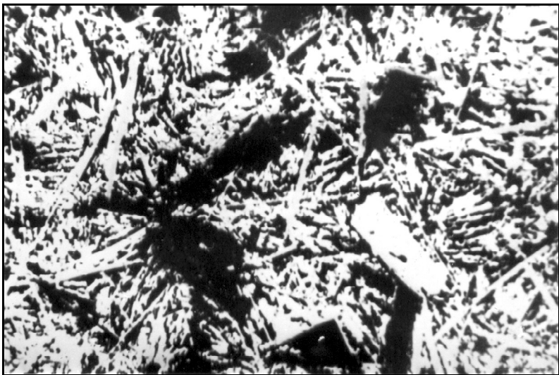
3. ábra. A jósvafői salak felületi csiszolata. N=200x.
