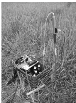
7. ábra Talajgáz-mintavétel az Ecoprobe 5 készülék szondacsővén keresztül (RS Dymanics Ltd, Prága, Csehország). A szondacső méretei: külső átmérő: 20 mm; talajlevegőcsonk távolsága a talptól: 6 cm; talajlevegőcsonk átmérője: 11 mm, mintaátvezető cső átmérője: 8 mm. A tömítő gallér méretei: alsó átmérő: 35 mm, felső átmérő: 59 mm, hossz: 98 mm.
