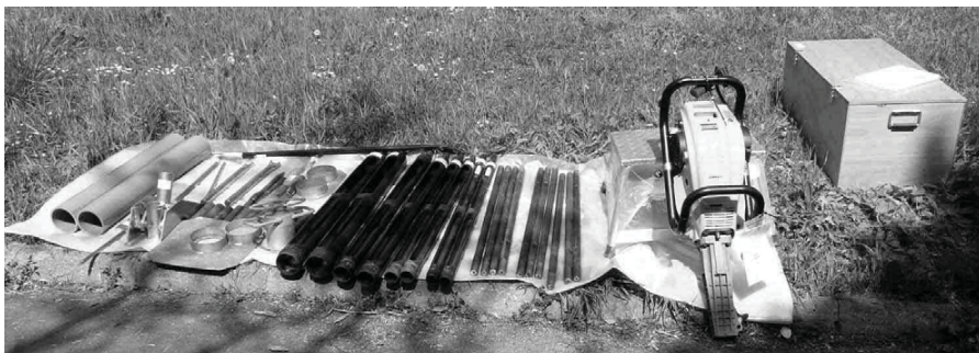
2. ábra A MONTABIO projekt keretében beszerezett Eijkelkamp fúrókészlet (Eijkelkamp Agrisearch Equipment BV, Giesbeek, Hollandia)
