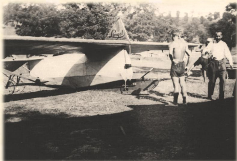
Lingel gyártású gép, burkolt törzssel. Zingó 226 nevet kapott z ilyen megoldású gép
