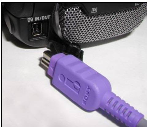
47. ábra: DV kamera csatlakozója
