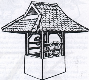
54. ábra. Velemér: Tókei Zsuzsa öntöttvas fogaskerékrendszerrel ellátott kútháza valóságos remekmű
