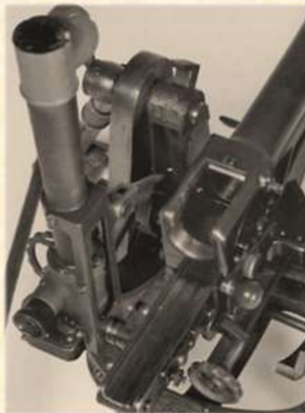
M15/3,7 cm gyalogsági ágyú zárszerkezet, lövegtávcső 397
