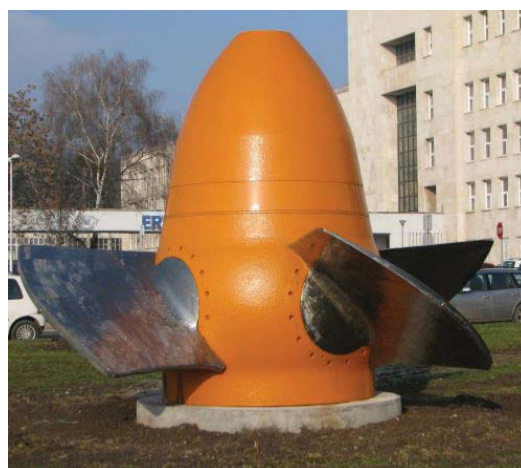
A Tiszaöki Kaplan turbina járókereke kiállítva a NME parkjában Miskolcon
