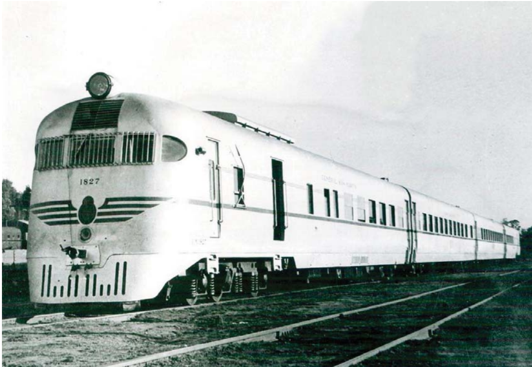
Az 1960-as években Argentínába szállított Ganz motorvonat, amelynek hajtóművében már hidrodinamikus nyomatékváltó volt
