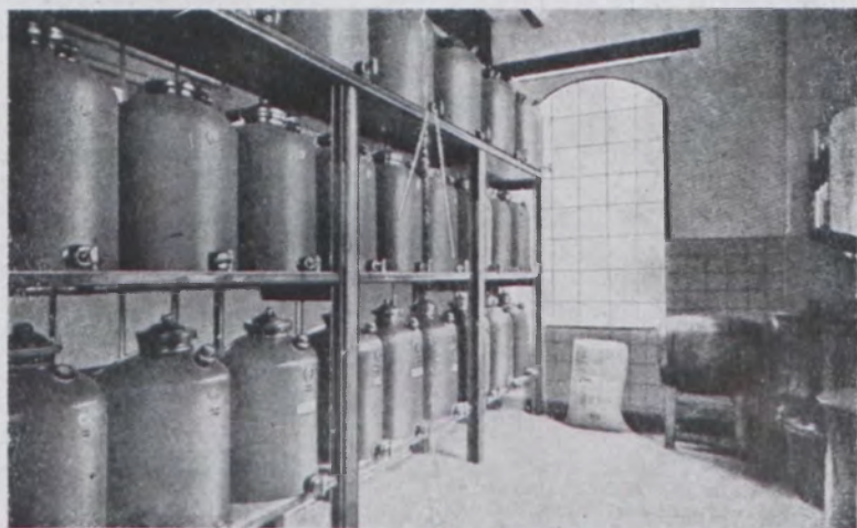
24. ábra. Likőr és likőrtest raktározása kőedényekben.
