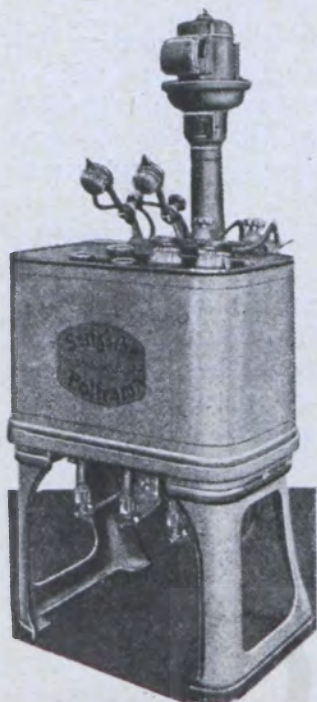
43. ábra. Seitz-féle „Polfram” villanymotoros palackmosógép.
