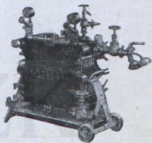
37. ábra. Seitz-féle „Ariston” réteges szűrő.
