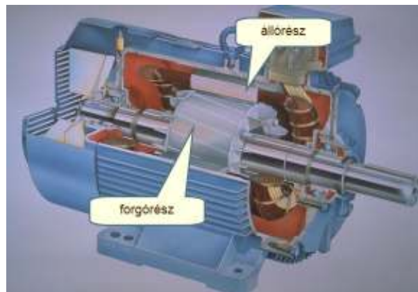
3.13. ábra. A háromfázisú aszinkronmotor szerkezete
