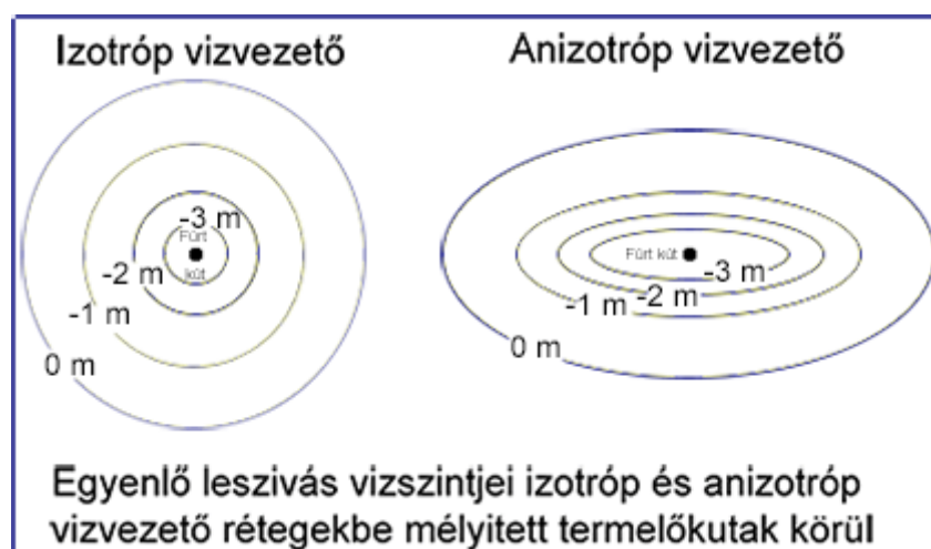
Ábra 10. Az áramlási szimmetria alakulása izotróp és anizotrop vízvezetőkben
