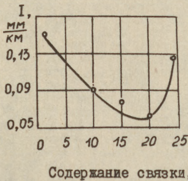
Рис.3. Влияние содержания связующего в режущем слое на интенсивность изнашивания резцов из БПК при точении стали ШХ15
