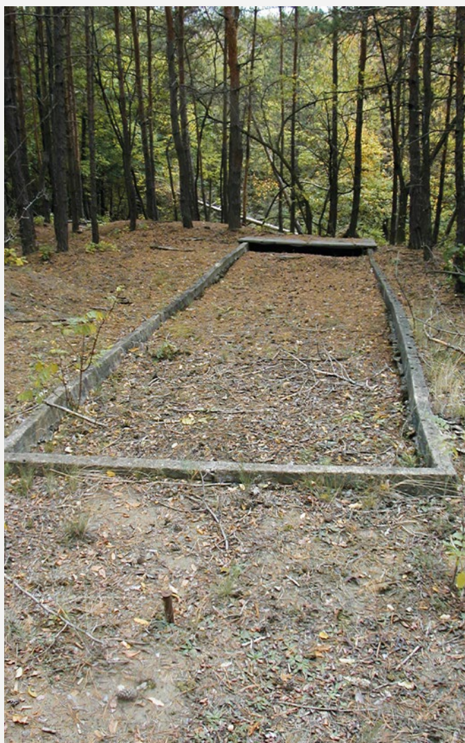
Felületi erózió meghatározása mintaparcellán az ERTI Kiskisnád melletti Dolina-völgyben kialakított kísérleti területén (©KP)
