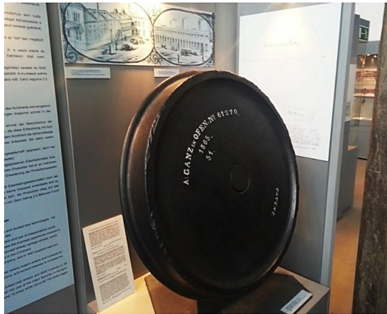
Ganz-féle kéregöntésű vasúti kerék 122
