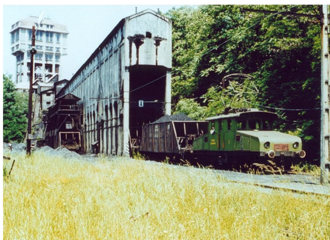
Ganz egyenáramú villamos mozdony Pécsbányatelep (Mecseki Szénbányák, 300 LE, készült 1914-ben) 791
