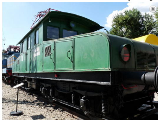
A Mecseki Szénbányák II. pályaszámú villamos mozdonya . Ganz és Társa Danubius, Gép-, Vagon és Hajógyár Rt., 1914. 786
