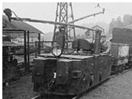
Siemens felsővezetékes bányamozdony az 1930-as évekből
