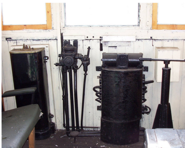
Mecseki Szénbányák III-as számú egyenáramú villamos mozdonyának vezérlőasztala Pécsbánya-rendező 2005 (300 LE, gyártó Ganz 1914) 789
