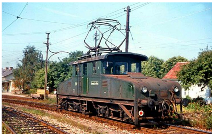
Osztrák Stern & Hafferl Vasút E 20 004 egyenáramú villamos mozdony Eferdingben 1973-ban (40 km/óra, 300 LE, gyártó Ganz, 1913, eredetileg a Pozsony-Országhatár HÉV Eg 6 mozdonya, 1941-ig, 1999-től Linzer Lokalbahn E22 004 804
