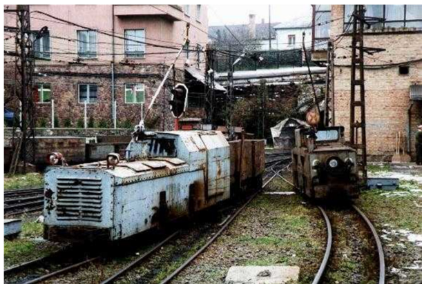
Komló, Ganz 9 tonnás bányamozdony, meghosszabbított vezetőállással 805
