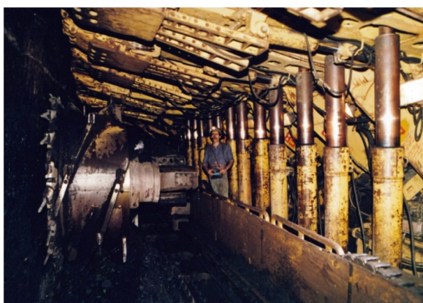
Putnok, 4 méter vastag széntelep fejtése (Hemscheidt pajzsok, Eickhoff maróhenger...)
