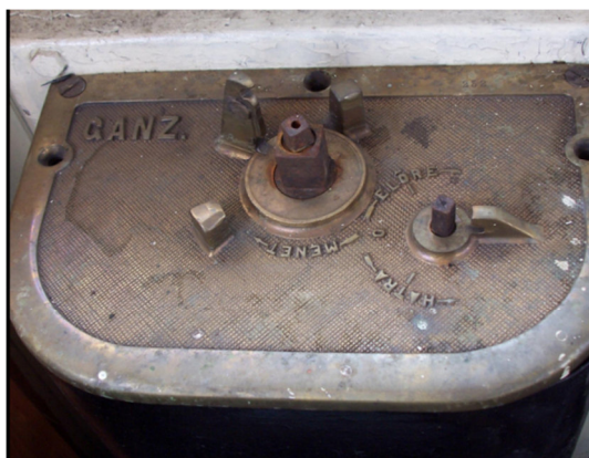
Mecseki Szénbányák III-as számú egyenáramú villamos mozdonyának vezérlőasztala Pécsbánya-rendező 2005 (300 LE, gyártó Ganz 1914) 789
