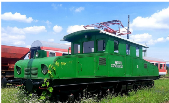
Mecseki Szénbányák III-as számú egyenáramú villamos mozdonya, 300 LE, gyártó a Ganz 1914-ben. Pécsbánya-rendező, 2019.06.22. 788
