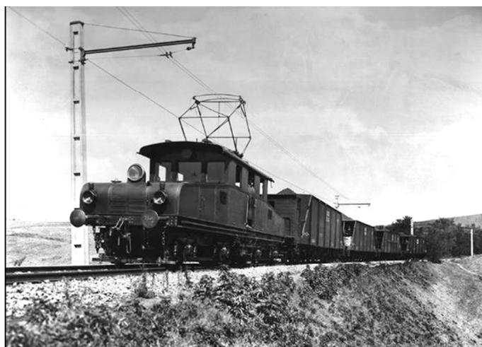
Mecseki Szénbányák egyenáramú villamos mozdonya úton a pécsújhegyi szénosztályozó felé (300 LE, gyártó Ganz 1914) 792
