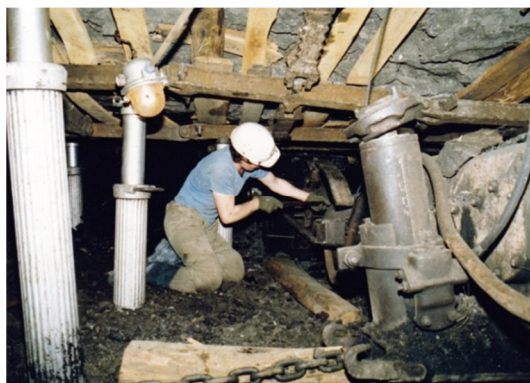
Edelény, vékonytelepi gépesített fejtés
