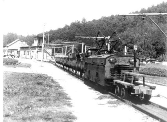
Ganz 6 tonnás bányamozdony, vezetőfülke nélkül, a farkaslyuki Gyürky táró előtt
