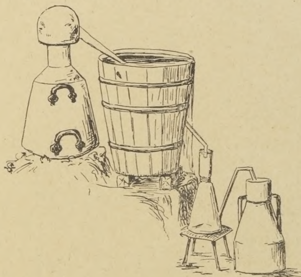
69. kép. Rózsaoaj lepárlására szolgáló egyszerű készülék Bulgáriában. (Szilárdy Z. nyomán.)
