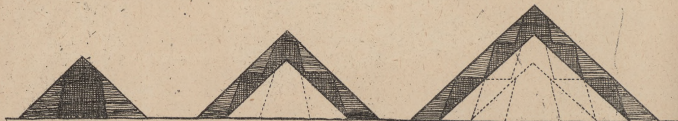
A PIRAMISOK FELEPÍTÉSÉNEK MÓDJA BÜRGSCH ÉS HOMMEL ELMÉLETE SZERINT
