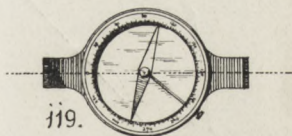
119. ábra. Mágnesűs szögmérő dioptrával.
