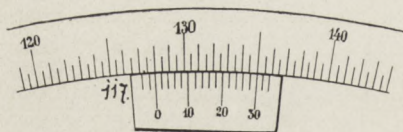
116. ábra. Szögmérő nónius 1 percz leolvasására. — 117. ábra. Szögmérő nónius 2 percz leolvasására.
