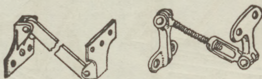
96. ábra. Ablakszárnyakat összekötő szerkezet behajló ablaknál.
