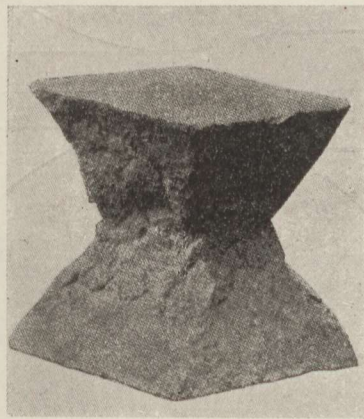
33 a ábra. A nyomás hatására szilárd tárgyból kitört kettős ékalakú darab. (E. Krause, Material-Prüfmaschinen.)
