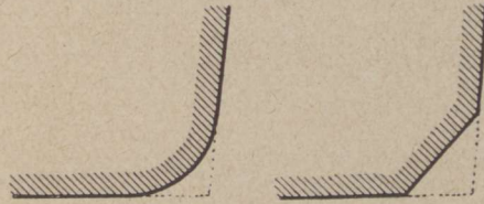
Abb. 55. Abrundung bzw. Abstumpfung der Kaliberecken.
