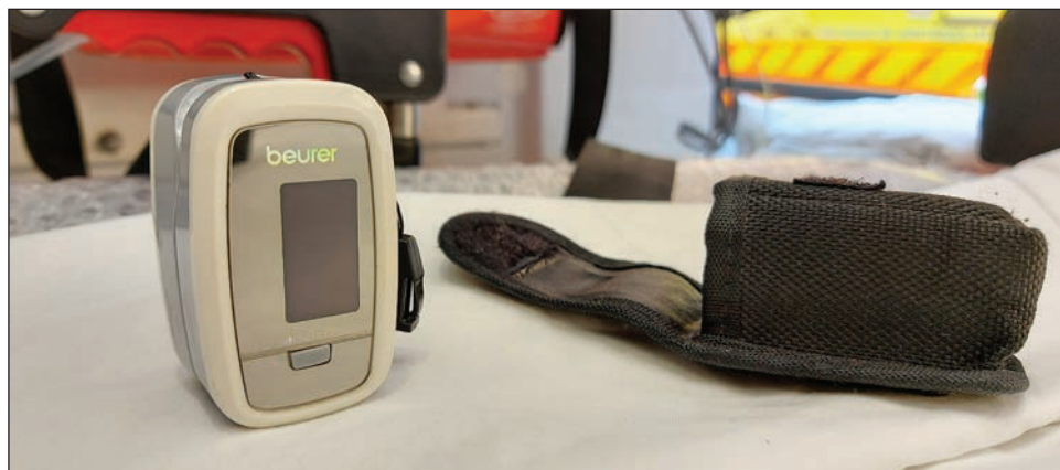
28. fotó. Elemmel üzemelő, a beteg ujjbegyére helyezhető, fotóelektronos érzékelős pulzoximéter, ami a medikus szűrőegységek legfontosabb diagnosztikai eszköze volt.
