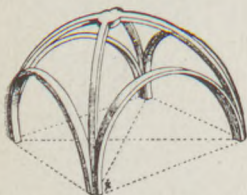
24. kép. A bordás keresztboltozat szerkezete.
