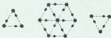
156. kép. A mészpát atómrácsa (fönt), az oxigén-atómok elhelyezkedése (lent).
