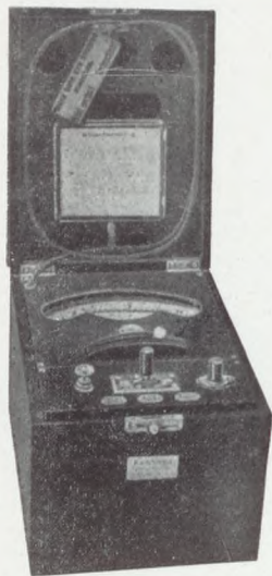
359. kép. A Fürstenau-féle intenziméter.
