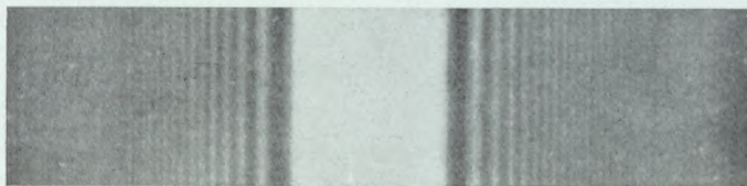
237. kép. Sugárszövődés vékony drót árnyékában. (Az eredeti nagyított fölvételről készült pozitív kép.)
