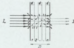
211. kép. A Röntgen-sugarak elnyelése és szétszóródása.
