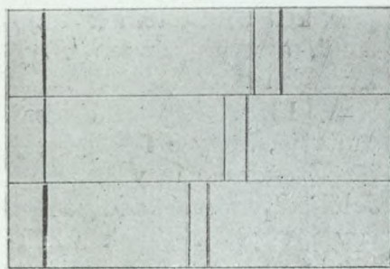
159. kép. A Siegbahn és Friman-féle spektrográffal készült fölvételek.
