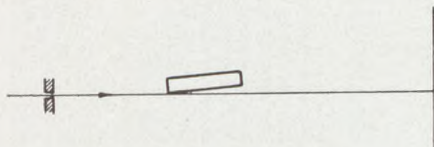
238. kép. Elhajlás üveglap szélé mentén.
