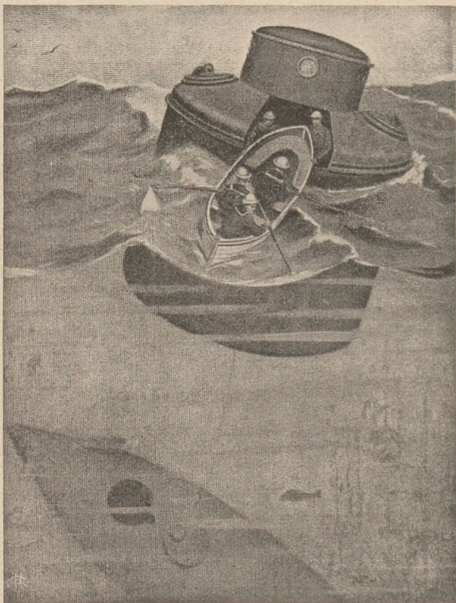
25. kép. Mentődob, mellyel a fenékre süllyedt naszából a személyzet a víz felszínére juthat.
