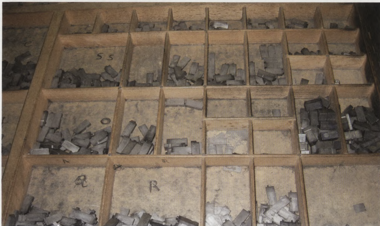
1. Betűtartó szekrény (casta), amelynek eltérő méretű rekeszeiben tartották a különböző mennyiségben igényelt betűket
