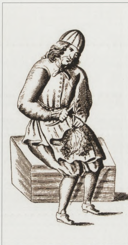
10. Festékező labda készítése lószőrből és bőrből
