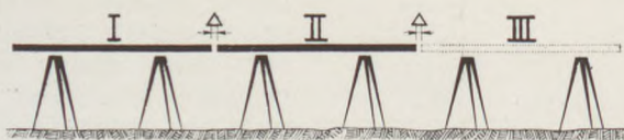
11. ábra. Véglapos mérőrúddal való mérés sémája (kontaktusos mérés).
