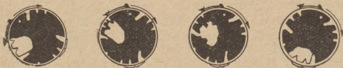
35. ábra. A vaj gyúrása zuhantatással verőléces köpülőben
