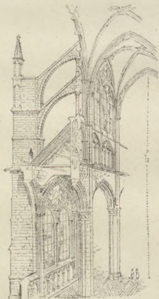
Csúcsíves bolthajtás támasztó rendszere. Az amiensi székes-egyházból.
