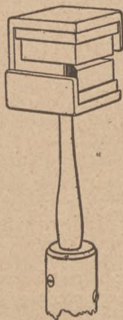
24. ábra. A Bauernfeind-féle kettős szögprizma perspektív képe.
