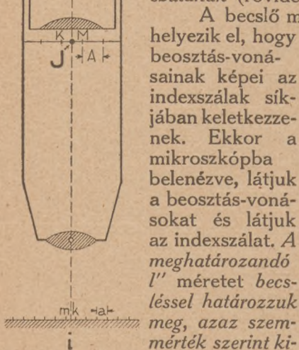
9. ábra. Becslő mikroszkóp sematikus hosszmetéte.
