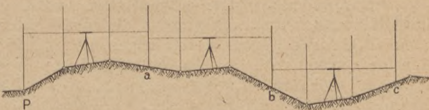
7. ábra. Hossz-szelvény felvétel színtezéssel.
