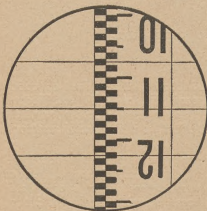
3. ábra. A távmérő távcső látómezeje a tahiméteres lécc képével.
