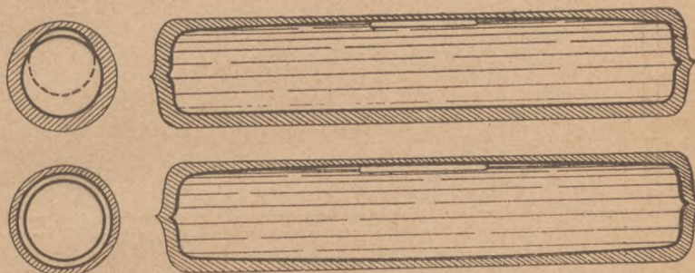
1. ábra. Részleges és teljes csiszolású csöves libellák hossz- és keresztmetszete.
