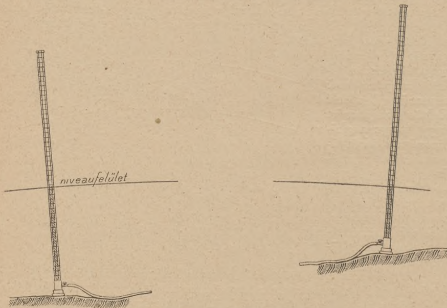
2. ábra. Szintezés közlekedő csővel.
